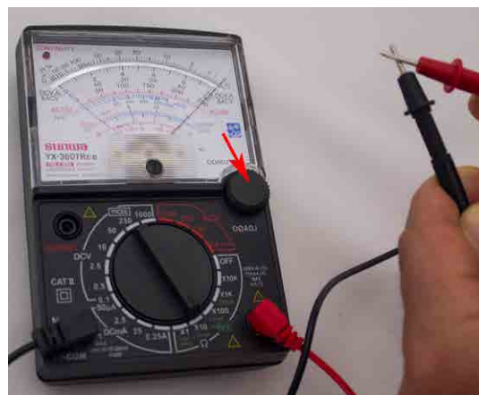
Figura 10: Aguja fijada en cero (derecha) girando la perilla de control de cero (ver flecha) mientras se juntan las puntas de los cables rojo y negro. Fuente: Tim Motis
