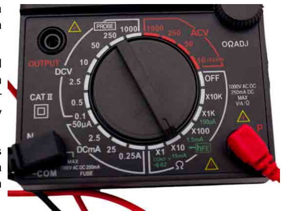
Figura 9: Los cables conectados al medidor fijado en X10 ohmios. Fuente: Tim Motis
