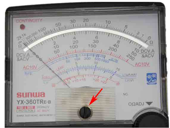
Figura 8: Aguja colocada sobre infinito con el medidor sin usar o apagado. El ajustador de cero, tal como lo muestra la flecha, puede girarse para ajustar la posición de la aguja. Fuente: Tim Motis
